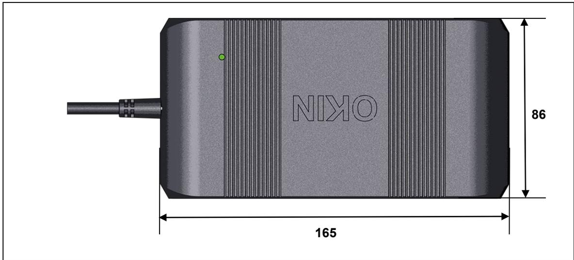
Abbildung 3 Maße der CU165, Draufsicht (Angaben in mm)
