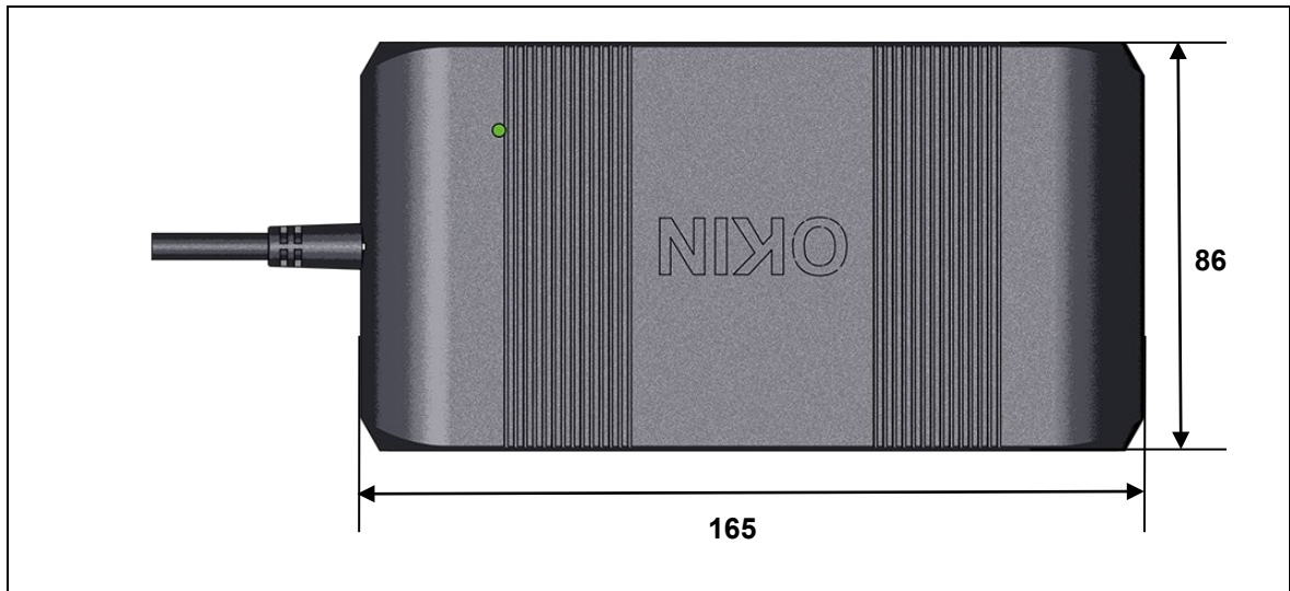
Abbildung 3 Maße der CU165, Draufsicht (Angaben in mm)
