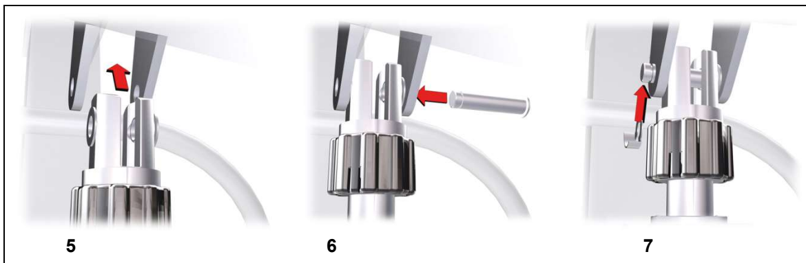
Abbildung 24 Montageschritte am Gabelkopf LR (Beispiel)
