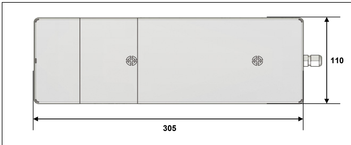
Abbildung 4 Maße des AG300, Draufsicht (Angaben in mm)
