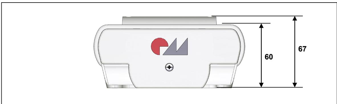
Abbildung 7 Maße der Steuerung ECS, Vorderansicht (Angaben in mm)
