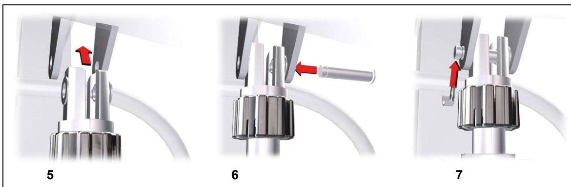
Abbildung 24 Montageschritte am Gabelkopf LR (Beispiel)
