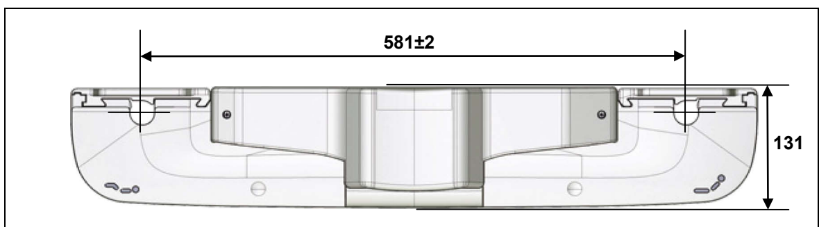
Abbildung 10 Maße des DUOMAT 9 (Angaben in mm)
