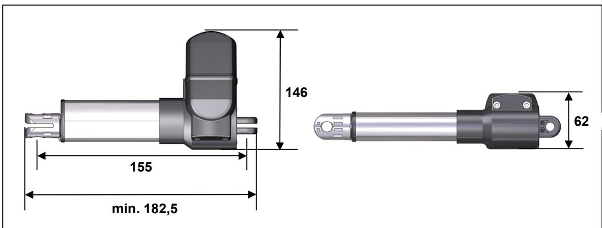
Abbildung 10 Maße des Antriebs ALPHADRIVE 3 Hubrohrsabelkopf (Schlitz 5 mm)
