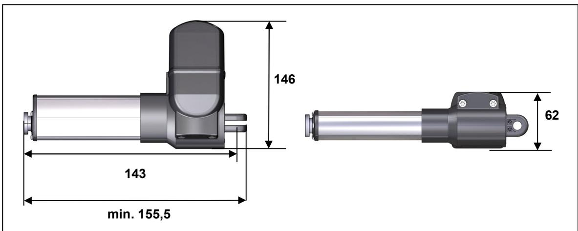
Abbildung 9 Maße des Antriebs ALPHADRIVE 3 mit Adapter (Angaben in mm)
