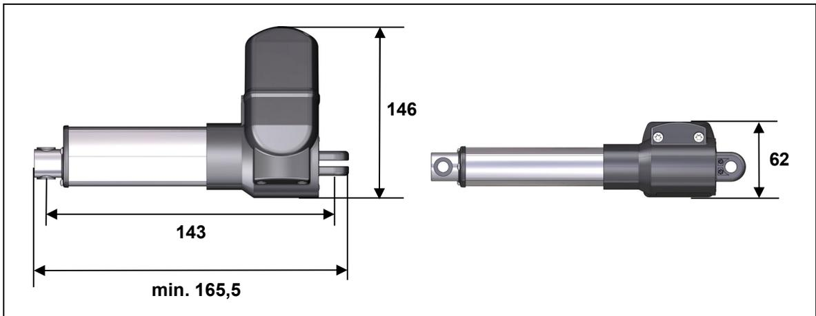
Abbildung 8 Maße des Antriebs ALPHADRIVE 3 Hubrohr mit Bohrung (Angaben in mm)
