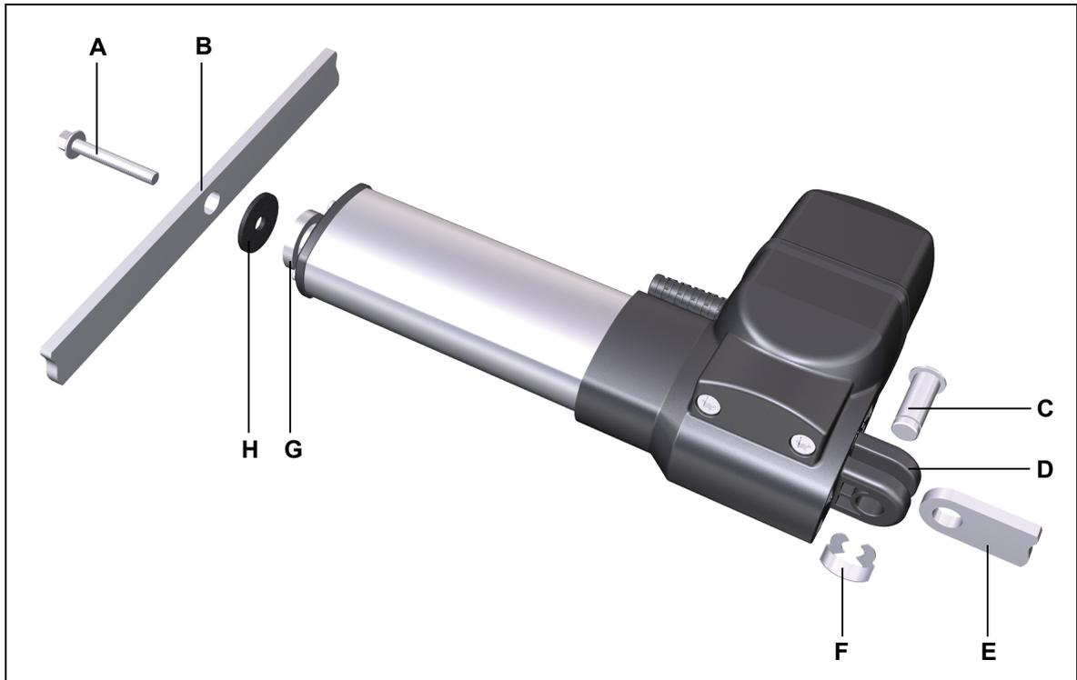
Abbildung 15 Einbau des Antriebs (Beispiel)
