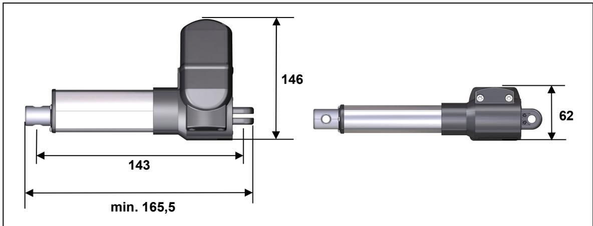
Abbildung 11 Maße des Antriebs ALPHADRIVE 3 Hubrohrkopf ohne Schlitz (Angaben in mm)
