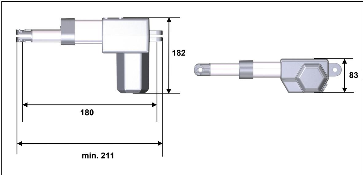
Abbildung 8 Maße des Antriebs DELTADRIVE mit Hubrohrgabelkopf (Angaben in mm)
