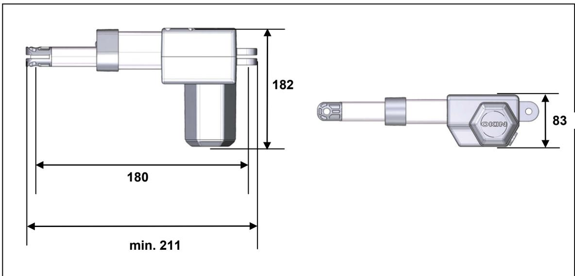
Abbildung 11 Maße des Antriebs DELTADRIVE mit Hubrohrkopf, Ausführung verstärkt (Angaben in mm), Mindest-Einbaumaß: 180 mm
