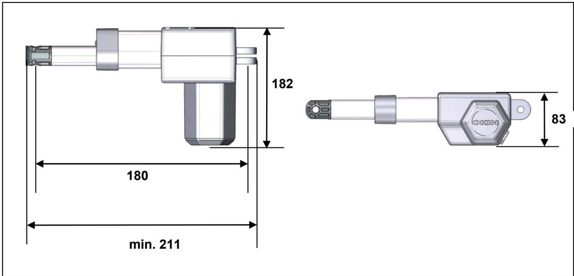
Abbildung 10 Maße des Antriebs DELTADRIVE mit Hubrohrkopf, Ausführung Guss (Angaben in mm), Mindest-Einbaumaß: 180 mm
