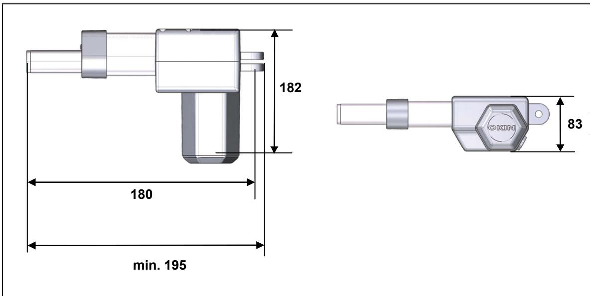
Abbildung 9 Maße des Antriebs DELTADRIVE mit Adapter (Angaben in mm)
