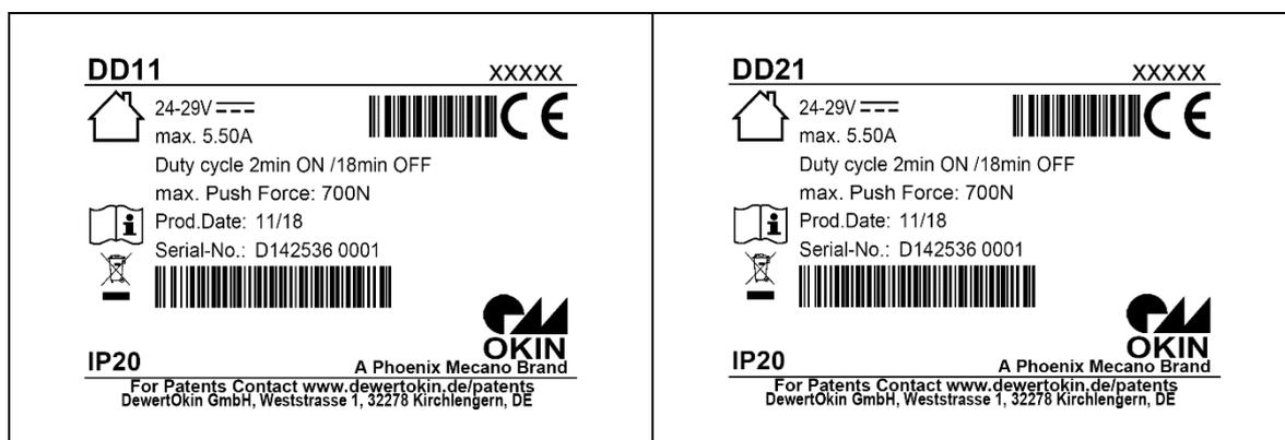
Abbildung 2 Typenschild (Beispiele Hubsäule DD11 / Hubsäule DD21)
