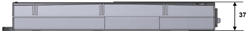
Abbildung 47 Steuerung COMPACT, Seitenansicht (Angaben in mm)
