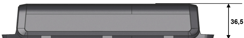
Abbildung 60 Steuerung SMARTneo / SMARTneo-pro, Seitenansicht (Angaben in mm)
