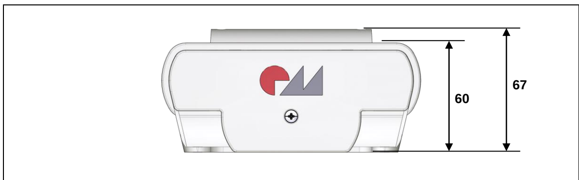
Abbildung 7 Maße der Steuerung ECS, Vorderansicht (Angaben in mm)
