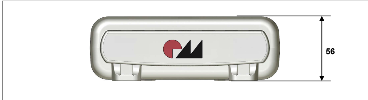
Abbildung 7 Maße der Steuerung MCL III, Vorderansicht (Angaben in mm)
