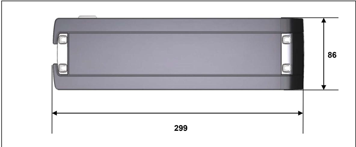
Abbildung 3 Maße der CONTROL UNIT HE-300, Draufsicht (Angaben in mm)
