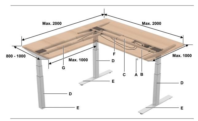
Figure 4Example: DD21S system with three DD21S lifting columns
