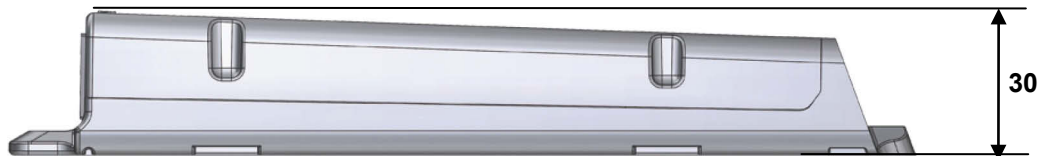
Abbildung 54 Steuerung SMART, Seitenansicht (Angaben in mm)
