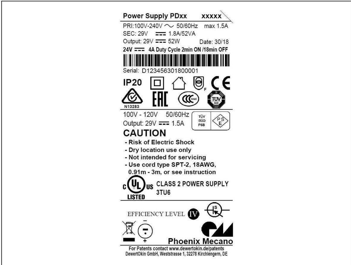
Abbildung 2    Beispiel: Typenschild POWER SUPPLY PD12 / PD13
