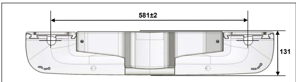
Abbildung 10 Maße des DUOMAT 9 (Angaben in mm)
