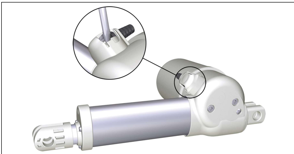
Abbildung 12 Lösbare Verriegelungskappe für steckbares Motorkabel
