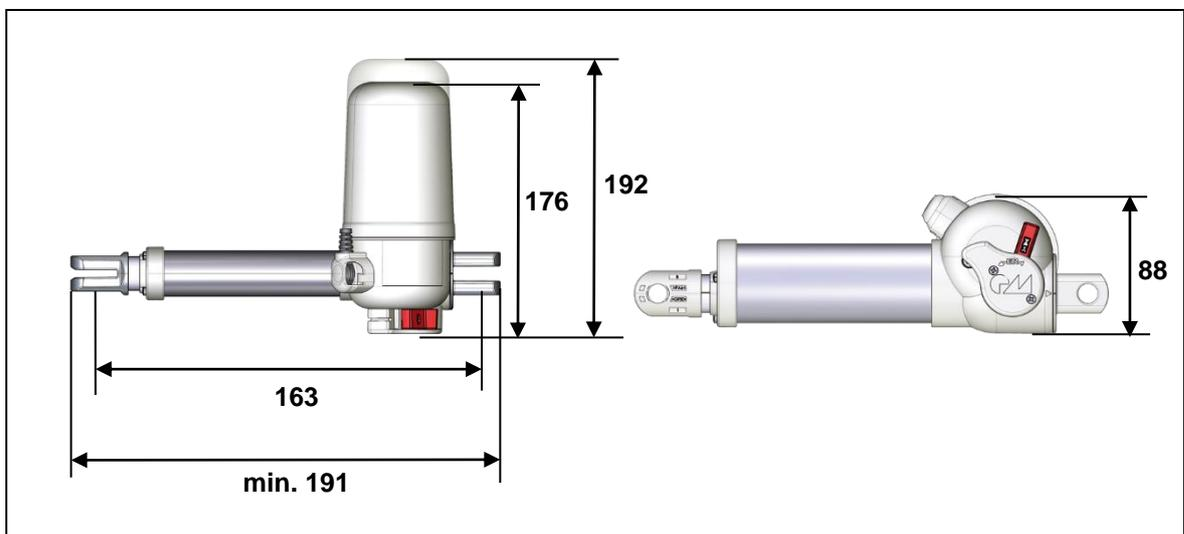
Abbildung 15 Maße des Antriebs MEGAMAT MCZ mit Rückstellfunktion (ER) mit Bowdenzug-
