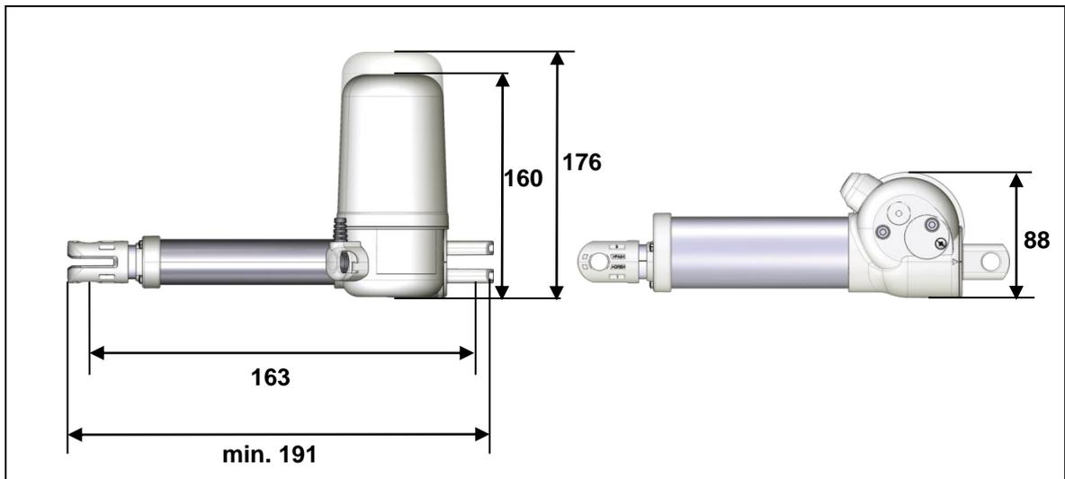
Abbildung 14 Maße des Antriebs MEGAMAT MCZ (Angaben in mm),
